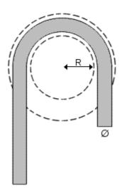
Biegeradius: "R" ist der Strahl vom kleinstmöglichen Kreis, in dem der Schlauch gebogen werden kann, ohne zu knicken.
